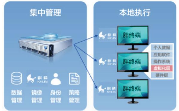
方案提供远程协助、一键还原桌面、全面兼容原有外设、显卡和声卡穿透、离线断网可用等功能。对于“行业特殊设备”，如加密盘、授权KEY、发票打印机、高速扫描仪等等，均可实现全面兼容。通过显卡和声卡穿透技术，完美实现3D实训机房、语音机房、考试机房等。
